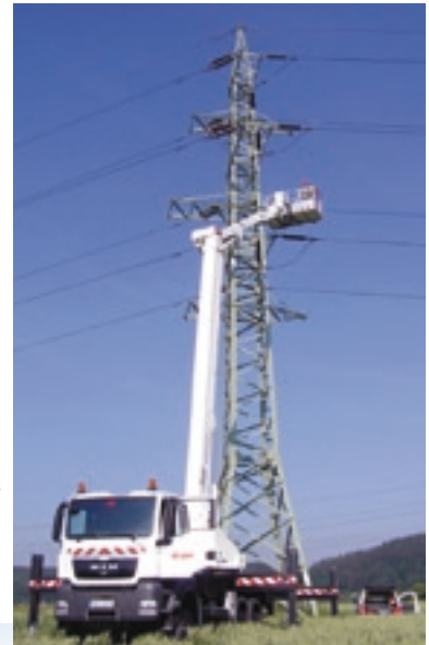
Skupina E.on využívá plošiny BRONTO Skylift S38XDT pro údržbu VN ve výškách až 38 m a náročném terénu
