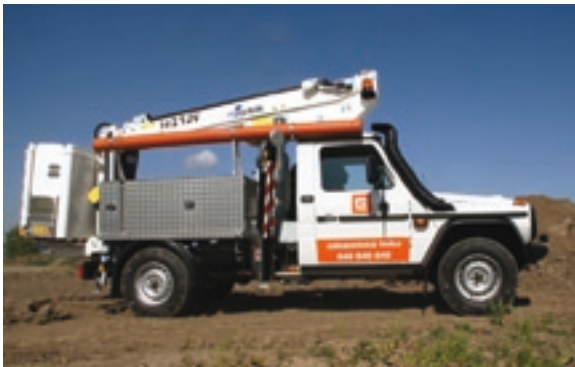
Pro společnost ČEZ dodáváme průběžně v letošním roce nástavby GSR E142TJV na podvozku Mercedes Benz G300. Pracovní výška 14,2 m, nosnost koše 230 kg, možnost práce bez ustavených opěr.
