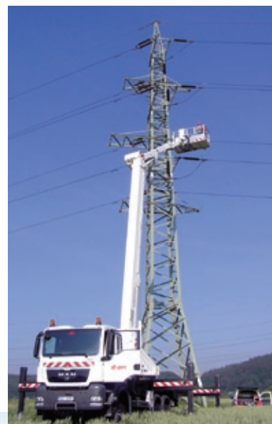
Skupina E.on využívá plošiny BRONTO Skylift S38XDT pro údržbu VN ve výškách až 38m a náročném terénu
