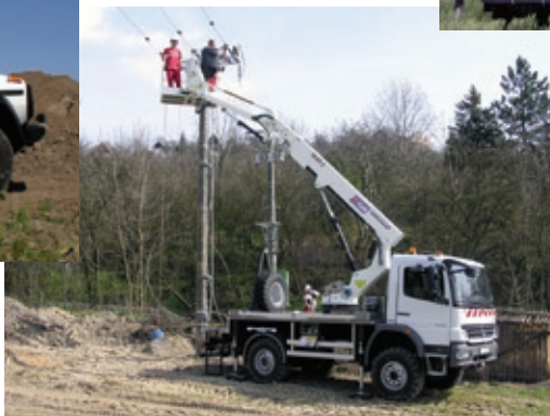
Společnost EMS z České Lípy používá již třetí rok plošinu GSR E162TJ na podvozku MB Atego. Pracovní výška 16m, velký stranový dosah, možnost použití koncového sklopného ramene.
