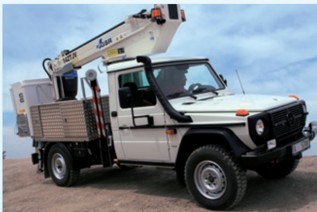
Plošina E142TJV na podvozku Mercedes Benz G300 s dvojitou izolací výložníku
